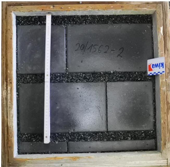
Abbildung 1: Pflastersteine mit Fugenmaterial in der Form verlegt (nach der Prüfung)
